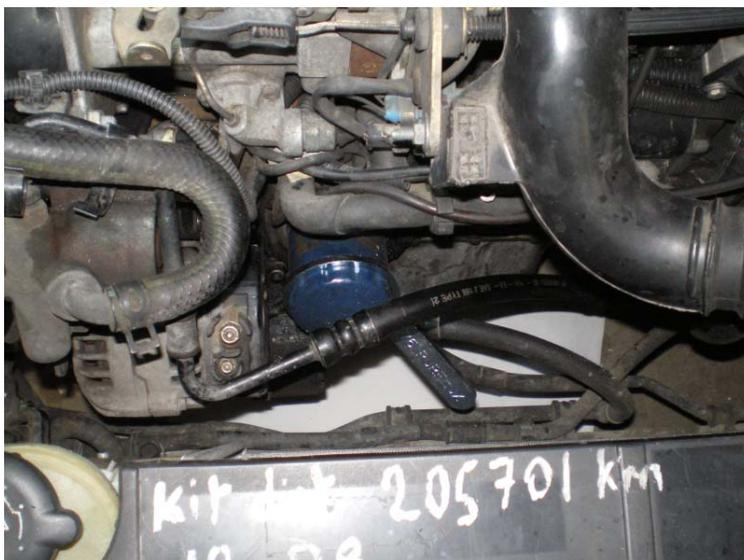
Sur les ZX équipées de la climatisation, la pompe de direction assistée est placée au dessus de l'alternateur. Le tuyau haute pression qui va de la pompe au vérin, en passant devant le moteur, nous empêche de sortir l'alternateur. Comme on ne peut pas non plus le sortir par le bas, il faut démonter ce tuyau.
