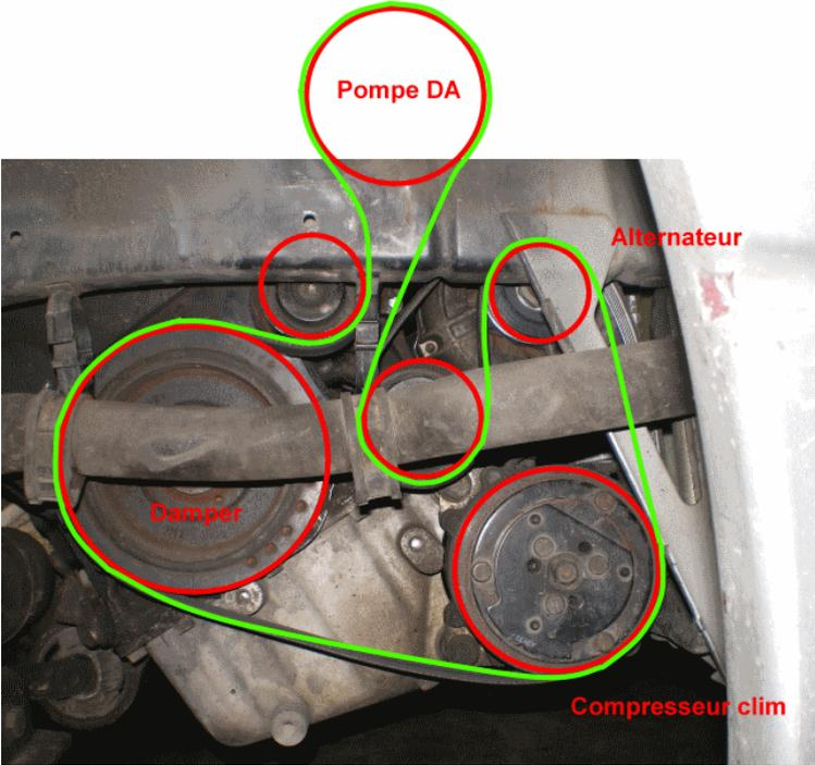
On tend la courroie grâce au trou carré dans lequel on place une rallonge d'1/4. Et on la bloque avec un embout Torx 50.
