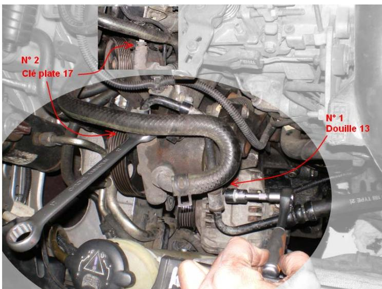
On peut maintenant écarter le tuyau, et le placer sur notre droite.
