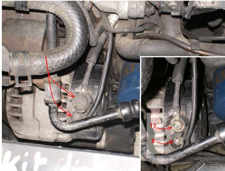
On peut maintenant démonter l'alternateur. Pour cela, commencer par la vis du bas. Je suis passé par-dessous, avec une douille de 17 et la rallonge longue.
