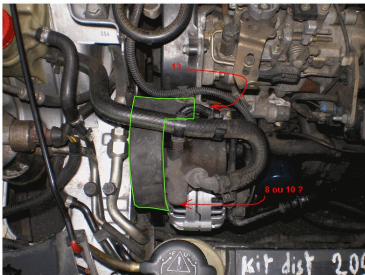
Détendre la courroie (utiliser pour cela un embout Torx de 50) et l'enlever.
