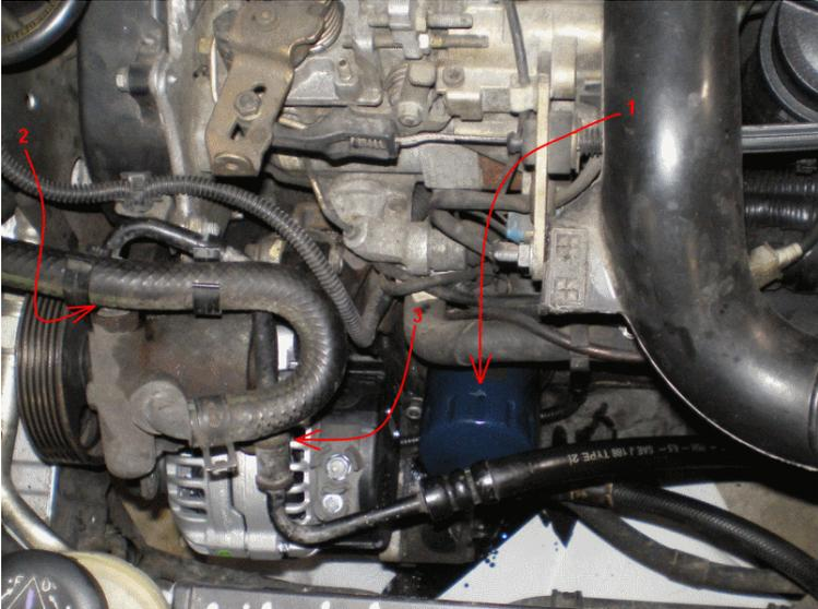
Ensuite, la courroie d'accessoire selon le cheminement suivant pour les ZX équipées de climatisation et de direction assistée.
