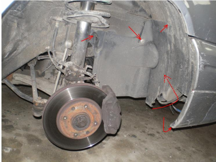
Enlever le cache de la courroie d'accessoire fixé autour de la pompe de direction assistée (douille de 13 et de 8 ou 10).
