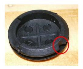
On commence par ouvrir le plip et sortir délicatement le circuit imprimé puis on enlève les restes de l'ancienne membrane (en haut à droite, ce qu'il me restait) :
