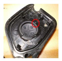
On peut voir sur la photo si dessus que la membrane fait des plis, un tournevis plat et fin permet de finir de la mettre en place sans blesser le caoutchouc.
