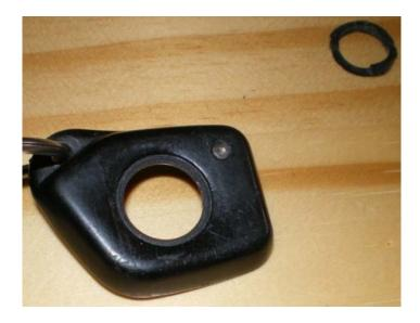
En met en place la nouvelle membrane par l'extérieur du plip en alignant l'encoche avec le repère dans le plip.
