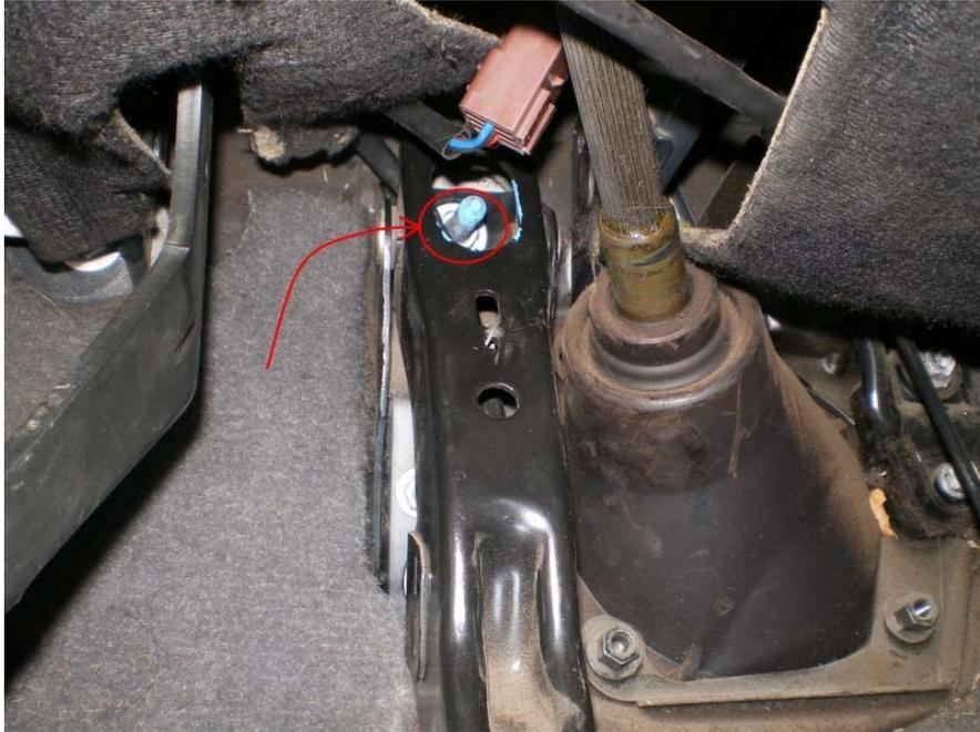
Voilà, vous avez maintenant la place et suffisamment de souplesse dans les différents éléments pour retirer votre capteur 2 broches et installer le capteur 3 broches.
