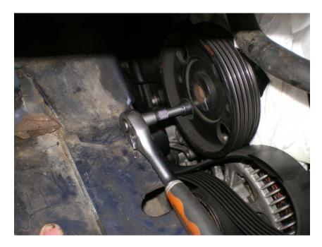
Petite astuce : il faut passer par un trou de la poulie pour accéder à la vis inférieur. Cette dernière ne peut sortir entièrement. Il suffit de la reculer de 3 – 4 cm, et on peut sortir la pompe (une fente est prévue pour laisser sortir la vis toujours en place)
