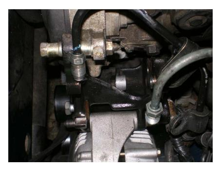
Au début, je disais que pour changer le galet tendeur, ce tuto pouvait être utilisé. Et bien c'est ici que ça se joue : il suffit de ne pas enlever l'écrou du haut du galet tendeur, et de dévisser complètement la vis dont je parle au dessus. Et hop, on sort la pièce numéro 3 (et on la change).
