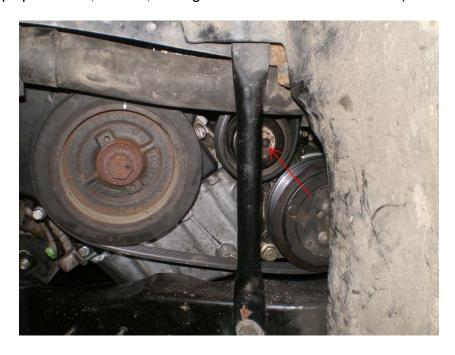
La courroie est encore en place sur la poulie de la pompe HP. Comme nous voulons déposer celle-ci, il faut déposer la courroie. On peut se contenter de l'enlever de la pompe HP, tout en la laissant sur le reste du parcours.
