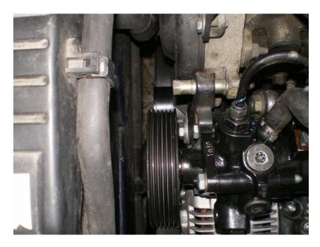
On va maintenant débrancher les tuyaux LHM de la pompe HP, autant éviter d'en mettre partout, on protège donc la zone avec du sopalin qui devrait tout absorber.
