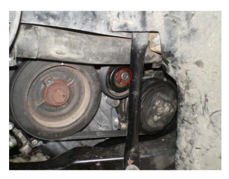
C'est ce carré qui permettra, à la fin, de régler la tension de la courroie :)
